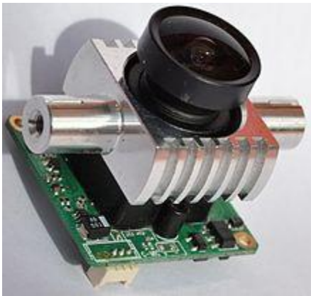
Optischer Sensor bestehend aus Linse, Wärmeableiter, Prozessor und Halterung
